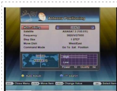
Этот режим позволит вам установить антенну, используя управляемые двигатели DiSEqC 1.3/2.0 системы USALS. Он включается кнопками **VOL**. ◀ ▶ в строке Motor Setting (настройка мотора). Перед началом использования этой системы внесите в память приемника Ваши географические координаты. Для этого нажмите кнопку **OK** в строке Satellite (спутник) и появившемся окне уточните (при необходимости) местоположение спутника и Ваши координаты (долготу и широту). В строке Command Mode кнопками
